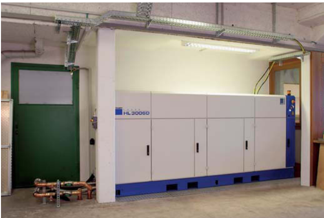
An zentraler Stelle aufgestellt versorgt der 3 kW-Laser von TRUMPF über das Laser Network zwei Bearbeitungsstationen mit Laserlicht.
